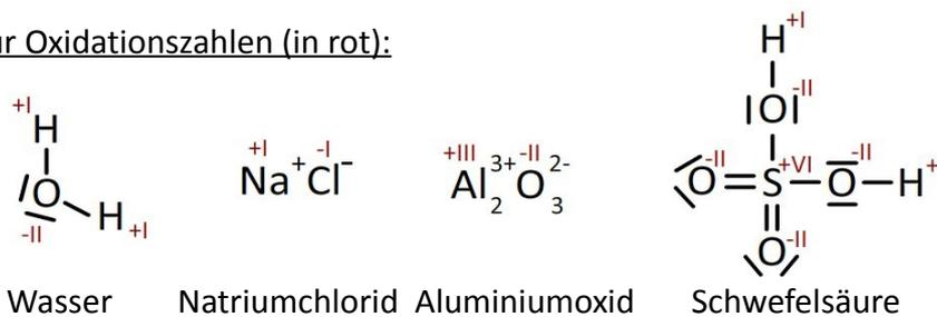
Die Regeln für Oxidationszahlen sind recht simpel. Man guckt sich jede einzelne Elektronenpaarbindung an und schiebt sie formal zu dem Atom, welches die höhere Elektronegativität besitzt. Bei Ionen ist dies natürlich hinfällig, da die Elektronen schon zum Atom mit der höheren Elektronegativität gewandert sind.
