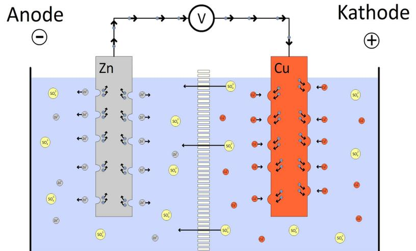
Man kann nun eine Spannung zwischen den beiden Halbzellen von 1,1 V messen. Zinkteilchen von der Elektrode gehen also in Lösung und geben dabei Elektronen ab, die zur Kupferelektrode wandern. Kupferionen aus der Salzlösung nehmen die Elektronen auf und setzen sich als elementares Kupfer an der Elektrode ab. Die Zinkelektrode löst sich also allmählich auf und die Kupferelektrode nimmt an Volumen zu. Die Reaktionsgleichungen sind also:
